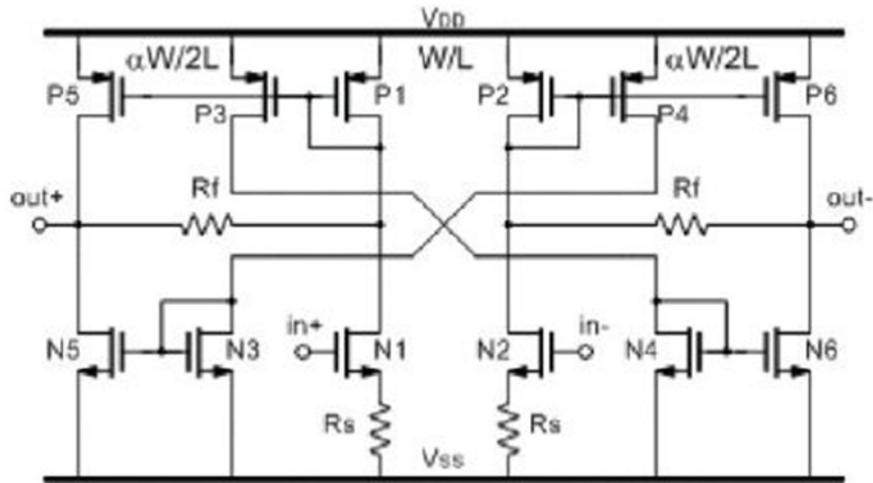
Figure 70: Gm – TIA VGA schematic
